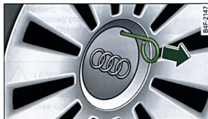
Rys. 253 Zmiana koła: zdejmowanie osłony piasty
