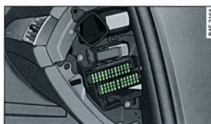
Rys. 271 Przykładowy wygląd podstawy bezpieczników
