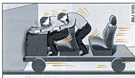
Rys. 195 Samochód uderza w ścianę
