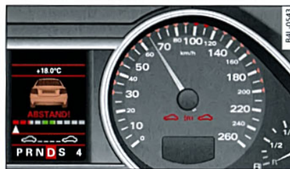
Rys. 154 Zestaw wskaźników: przejęcie regulacji przez kierowcę
