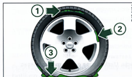
Rys. 261 Uszkodzenia, których nie można usunąć przy użyciu systemu mobilności opon
