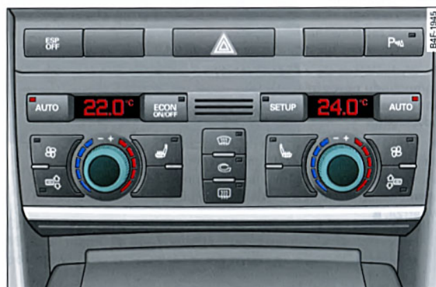
Rys. 114 Elementy obsługi układu klimatyzacji
