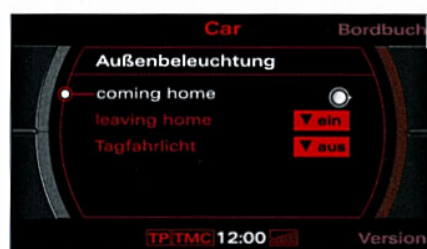
Rys. 57 Wyświetlacz MMI: oświetlenie zewnętrzne
