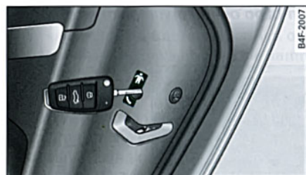
Rys. 45 Blokada otwarcia od wewnątrz, w tylnych drzwiach
