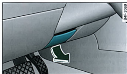
Rys. 133 Dźwignia pod kolumną kierownicy
