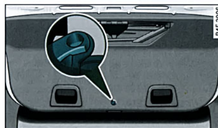
Rys. 44 Fragment wewnętrznej strony pokryw bagażnika: dostęp do awaryjnego odblokowania
