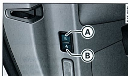
Rys. 39 Przednia część drzwi kierowcy: przycisk systemu kontroli wnętrza i zabezpieczenia przy holowaniu
