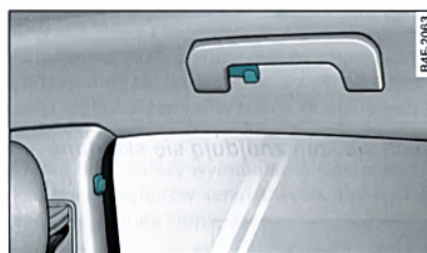
Rys. 105 Fragment nad drzwiami i obok tylnych drzwi: Wieszaki do odzieży
