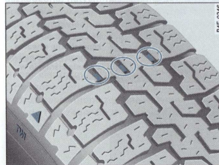
Rys. 250 Profil opony: wskaźnik zużycia
