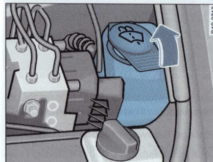
Rys. 247 Przedział silnikowy, z lewej strony z przodu: zbiornik płynu do mycia szyb
