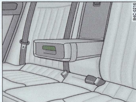
Rys. 257 Środkowy podłokietnik na tylnych siedzeniach: schowek na apteczkę
