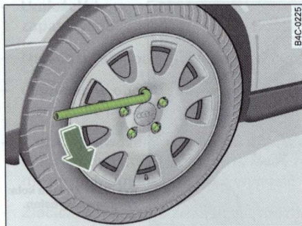
Rys. 265 Zmiana koła: luzowanie śrub
