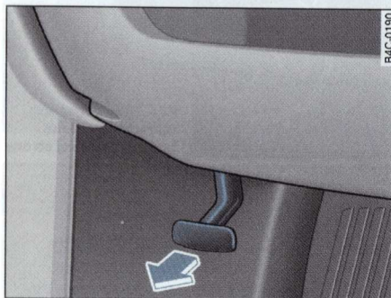
Rys. 238 Fragment przestrzeni na nogi kierowcy: dźwignia blokady
