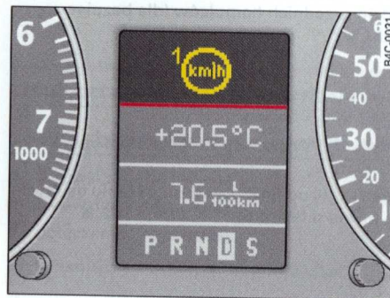
Rys. 20 Wyświetlacz: ostrzeżenie o przekroczeniu prędkości
