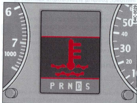
Rys. 17 Wyświetlacz: sygnalizacja poziomu płynu chłodzącego
