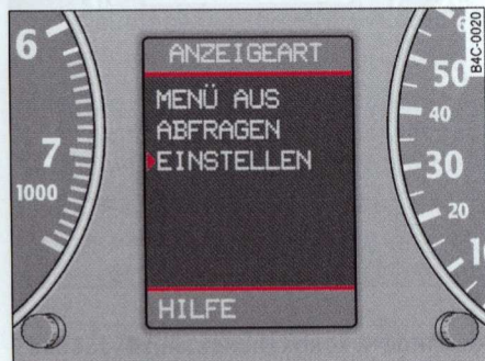
Rys. 34 Wyświetlacz: menu początkowe, wybrana funkcja EINSTELLEN (nastawianie)
