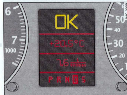
Rys. 11 Fragment zestawu przyrządów: wyświetlacz FIS z komputerem samochodowym
