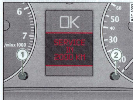
Rys. 8 Fragment zestawu przyrządów: wskazanie terminu przeglądu
