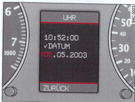
Rys. 37 Wyświetlacz: wybrane zostanie menu UHR, Datum (zegar, data)
