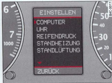
Rys. 31 Wyświetlacz: wybrane menu EINSTELLEN, COMPUTER (nastawianie, komputer)
