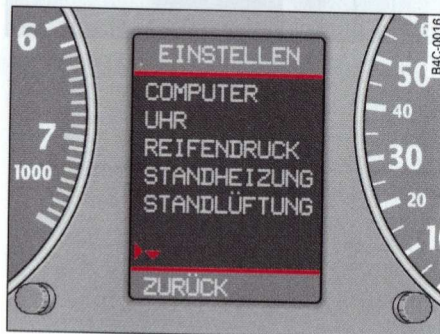
Rys. 30 Wyświetlacz FIS: menu EINSTELLEN (nastawianie), wybrana następna strona
