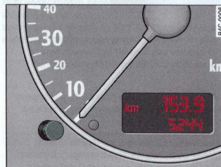
Rys. 6 Fragment zestawu przyrządów: licznik kilometrów z pokrętkiem zerowania
