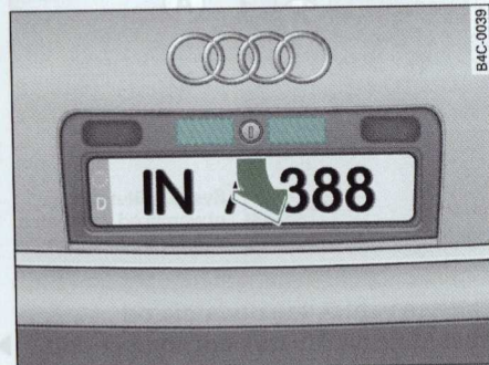
Rys. 50 Ukryte uchwyty z zamkiem pokrywy tylnej
