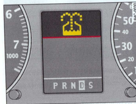
Rys. 19 Wyświetlacz: poziom płynu do mycia szyb za niski
