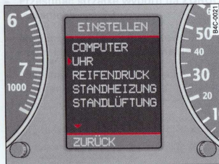
Rys. 35 Wyświetlacz: wybrane menu EINSTELLEN, UHR (nastawianie, zegar)
