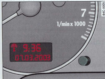
Rys. 5 Fragment zestawu przyrządów: pole wyświetlania symbolu odbioru fal radiowych, czasu zegarowego i daty
