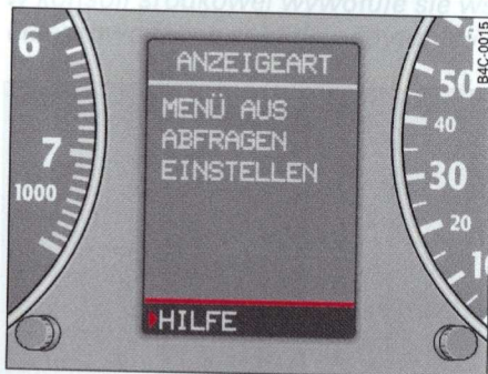
Rys. 29 Wyświetlacz FIS: menu początkowe, wybrana funkcja HILFE (pomoc)
