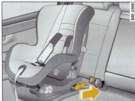
Rys. 213 Fotelik dla dziecka - ISOFIX zostaje wsunięty w uchwyt mocujący
