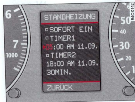
Rys. 142 Wnętrze samochodu: wyświetlacz FIS, menu STANDHEIZUNG (ogrzewanie postojowe), czas uruchomienia zegara 1
