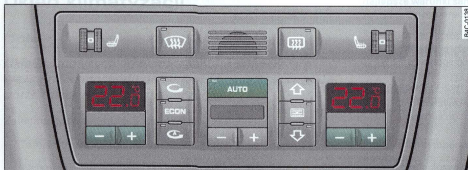
Rys. 137 Elementy obsługi układu klimatyzacji
