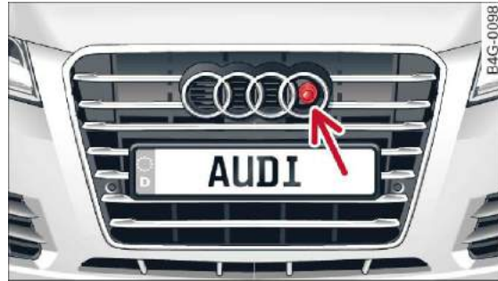
Rys. 136 Przód samochodu: kamera noktowizyjna
