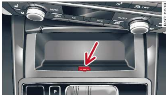
Rys. 105 Konsola środkowa z przodu: awaryjne odblokowanie dźwigni przełączania
