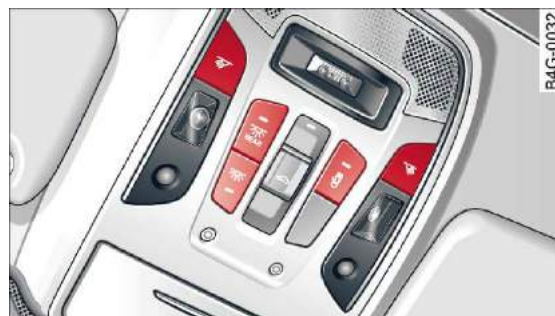
Rys. 36 Tapicerka dachu z przodu: elementy obsługi oświetlenia wewnętrznego
