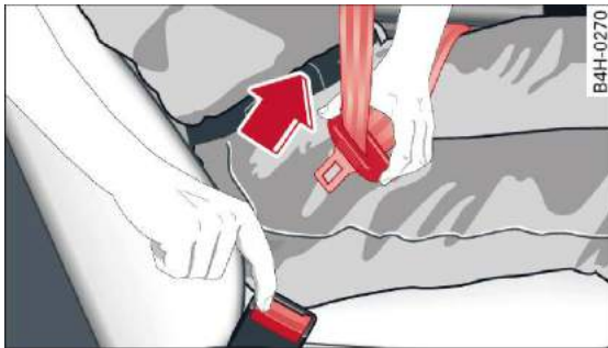
Rys. 193 Odpięcie zaczepu z zamka pasa
