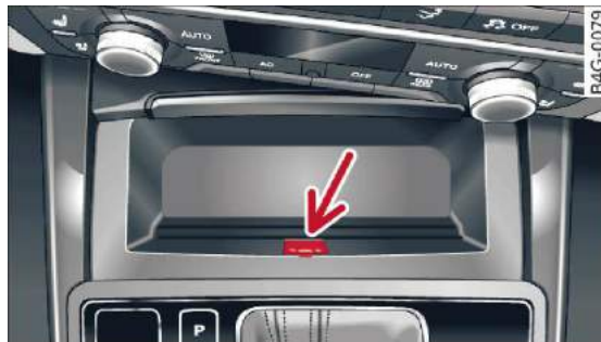
Rys. 98 Konsola środkowa z przodu: awaryjne odblokowanie dźwigni przełączania
