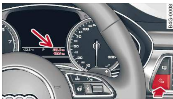
Rys. 10 Zestaw wskaźników: licznik kilometrów i przycisk zerowania
