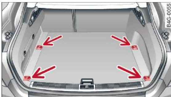
Rys. 66 Przestrzeń bagażnika: rozmieszczenie zaczepów do wiązania
