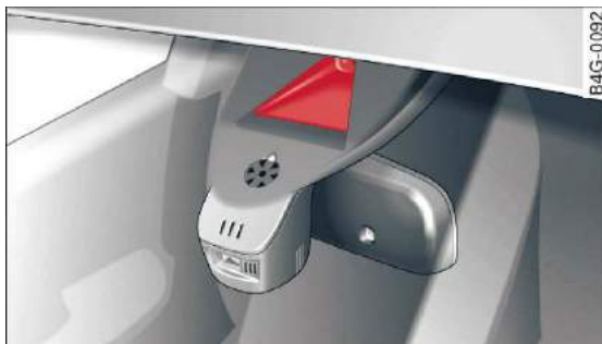
Rys. 118 Przednia szyba: okno kamery dla systemu active lane assist
