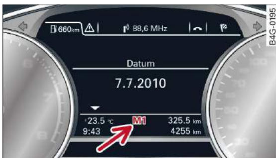
Rys. 96 Wyświetlacz: przełączanie ręczne (tryb pracy tiptronic)
