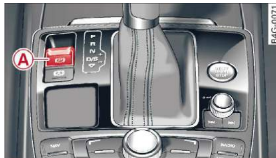
Rys. 85 Konsola środkowa: hamulec parkowania
