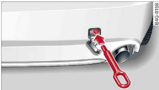
Rys. 248 Zderzak z tyłu: wkręcone ucho holownicze*
