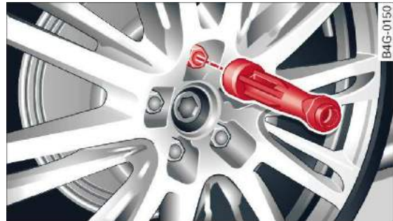
Rys. 240 Wymiana koła: klucz do śrub z wewnętrznym sześciokątem
