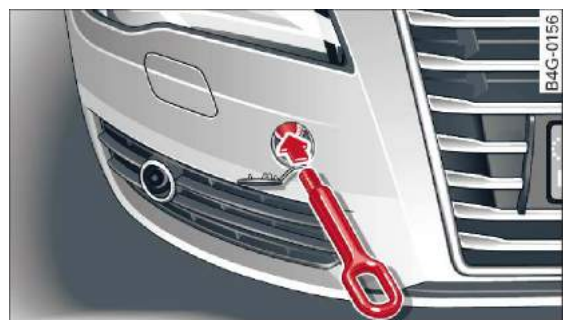
Rys. 246 Zderzak z przodu: wkręcanie ucha holowniczego
