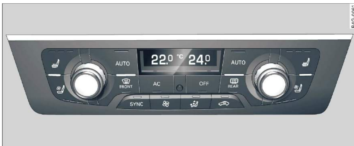
Rys. 74 Komfortowy układ klimatyzacji: elementy obsługi
