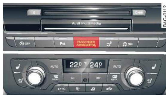
Rys. 203 Konsola środkowa: lampka ostrzegawcza wyłączonej poduszki bezpieczeństwa pasażera
