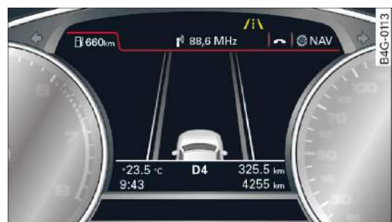
Rys. 120 Zestaw wskaźników: system active lane assist jest włączony, jednak nie jest gotowy do użycia
