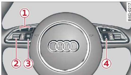
Rys. 6 Kierownica wielofunkcyjna: obsługa systemu informowania kierowcy
