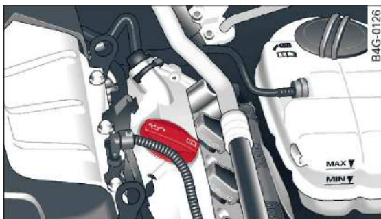
Rys. 219 Przedział silnikowy: korek wlewu oleju
