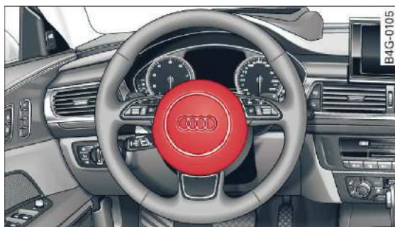
Rys. 194 Kierownica: poduszka bezpieczeństwa kierowcy
