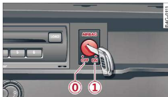
Rys. 202 Przedni schówek: wyłącznik na kluczyk do wyłączenia poduszki przedniego pasażera
