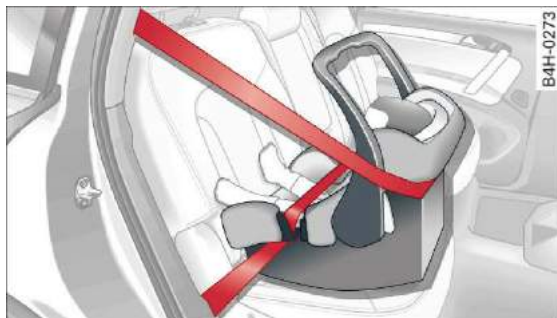
Rys. 178 Tylne siedzenia: fotelik dla dziecka ustawiony tyłem do kierunku jazdy
