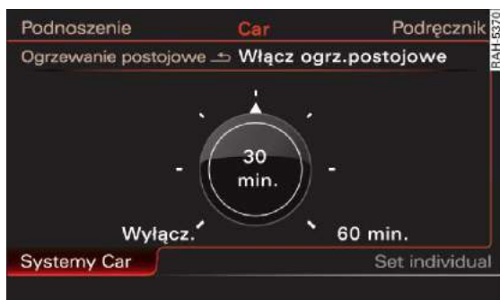
Rys. 77 Wyświetlacz MMI: natychmiastowe włączanie/wyłączanie ogrzewania postojowego
