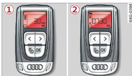
Rys. 79 Zdalne sterowanie ogrzewania postojowego: ① natychmiastowe włączanie, ② nastawianie timera
