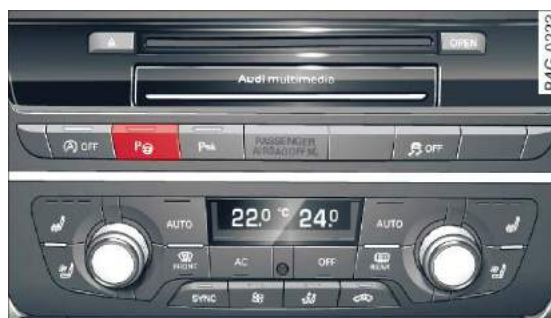
Rys. 168 Konsola środkowa: przycisk asystenta parkowania
