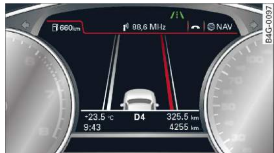
Rys. 119 Wyświetlacz: system active lane assist jest włączony i ostrzega
