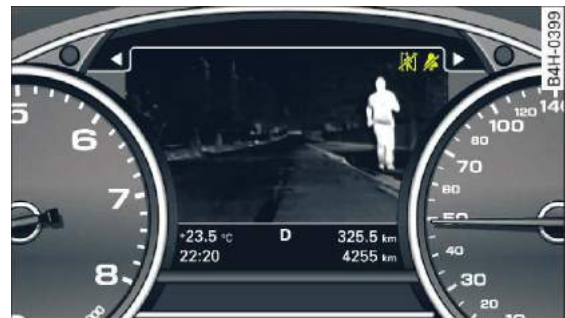
Rys. 138 Wyświetlacz: przykład, włączone oznaczenie pieszych i gong
