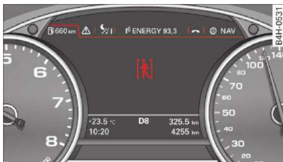
Rys. 135 Wyświetlacz: ostrzeganie o pieszych przy innym wskazaniu
