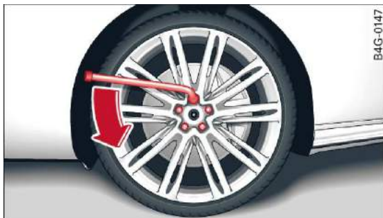
Rys. 237 Wymiana koła: luzowanie śrub koła
