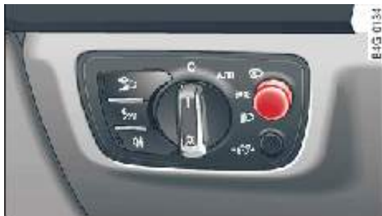
Rys. 15 Tablica przyrządów: przycisk wyświetlacza Head-up
