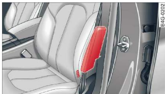
Rys. 198 Miejsce zamontowania poduszki bocznej w siedzeniu kierowcy
