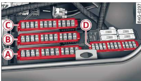
Rys. 252 Przestrzeń bagażnika: listwa bezpieczników z pałąkiem z tworzywa
