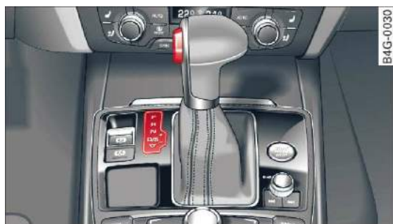
Rys. 94 Fragment konsoli środkowej: dźwignia przełączania z przyciskiem blokującym
