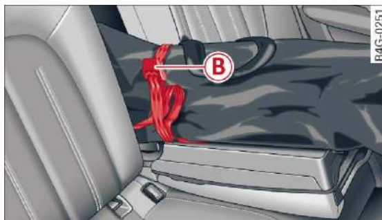
Rys. 72 Tyłne siedzenie: wiązanie ładunku
