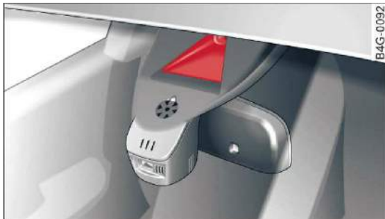
Rys. 140 Przednia szyba: wziernik kamery dla wskazania limitu prędkości
