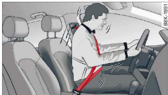
Rys. 183 Kierowca przytrzymany pasem bezpieczeństwa podczas nagłego hamowania.
