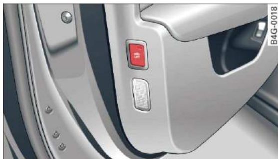
Rys. 24 Czołowa strona drzwi kierowcy: przycisk systemu kontroli wnętrza/systemu zabezpieczenia przy holowaniu
