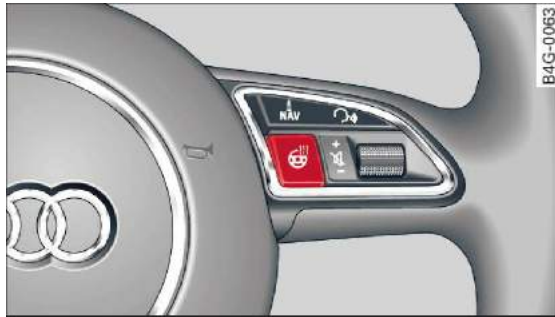
Rys. 76 Kolumna kierownicy: przycisk ogrzewania kierownicy
