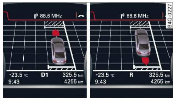
Rys. 172 Wielokrotne manewrowanie w miejscu parkingowym
