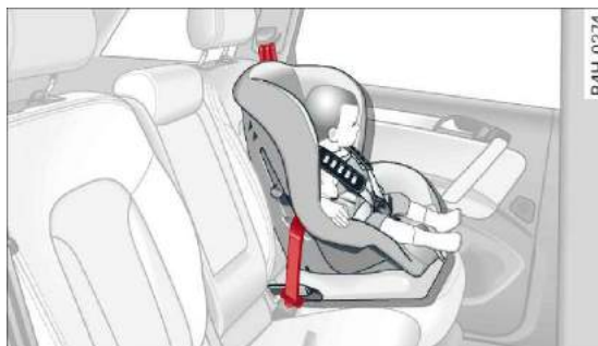
Rys. 179 Tylne siedzenia: fotelik dla dziecka ustawiony przodem do kierunku jazdy
