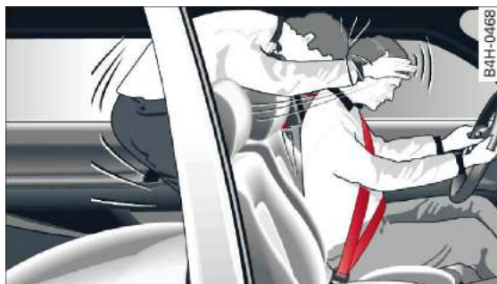
Rys. 187 Pasażer na tylnym siedzeniu, nie przypięty pasem zostaje wyrzucony do przodu
