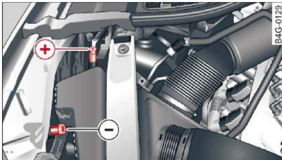
Rys. 243 Przedział silnikowy: przyłącza przewodów do wspomagania rozruchu i urządzenia do ładowania
