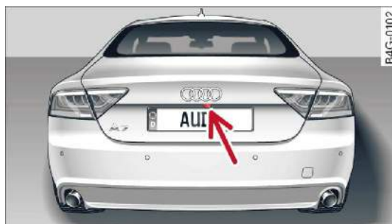
Rys. 148 Pokrywa bagażnika: usytuowanie kamery wstecznej
