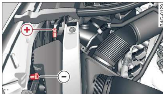
Rys. 222 Przedział silnikowy: podłączenie urządzenia do ładowania i przewodów wspomaganie rozruchu
