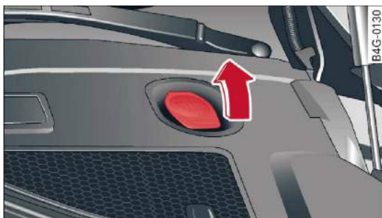
Rys. 223 Przedział silnikowy: zbiornik płynu do mycia szyb
