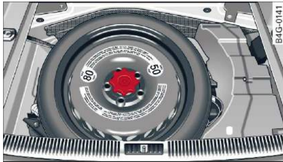
Rys. 232 Przestrzeń bagażnika: koło małogabarytowe (awaryjne)
