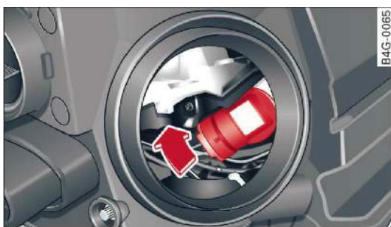
Rys. 256 Reflektor: wymontowanie żarówki światła uniwersalnego/światła skręcania*
