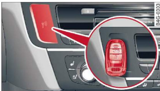
Rys. 84 Konsola środkowa/kluczyk z pilotem: uruchamianie silnika w razie niesprawności
