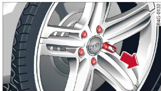
Rys. 236 Wymiana koła: zdejmowanie oston śrub
