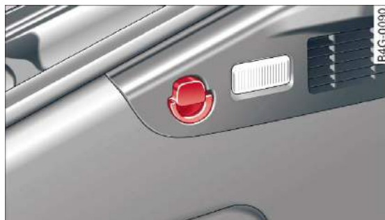
Rys. 68 Przestrzeń bagażnika: haki mocujące
