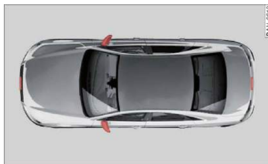
Rys. 153 Miejsca zamontowania kamer otoczenia
