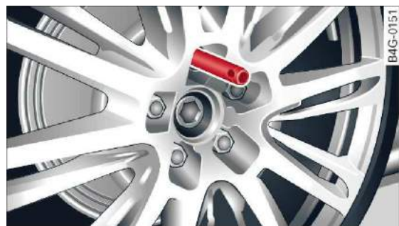
Rys. 241 Wymiana koła: trzpień montażowy w najwyższym położonym otworze
