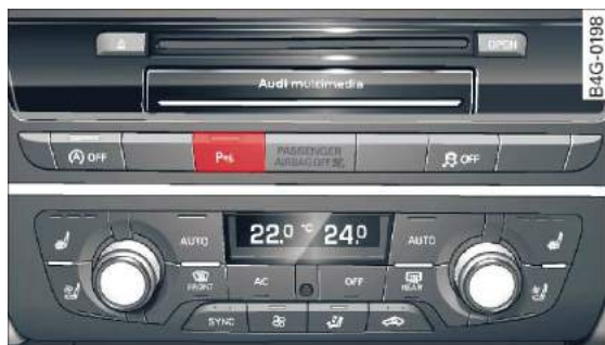
Rys. 143 Konsola środkowa: przycisk sygnalizacji podczas parkowania
