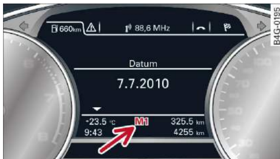
Rys. 103 Wyświetlacz: przełączanie ręczne (tiptronic)
