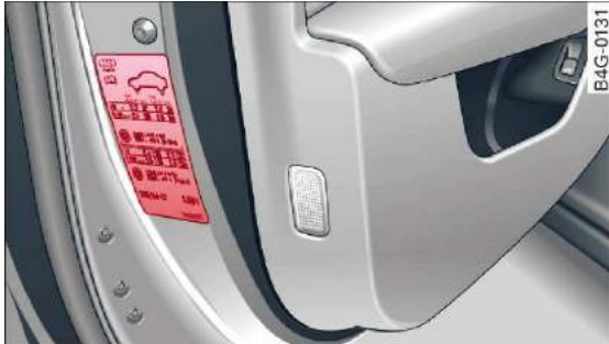
Rys. 224 Drzwi kierowcy: tabelka z wartościami ciśnienia w oponach
