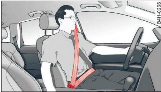
Rys. 188 Ustawienie zagłówków i ułożenie pasa
