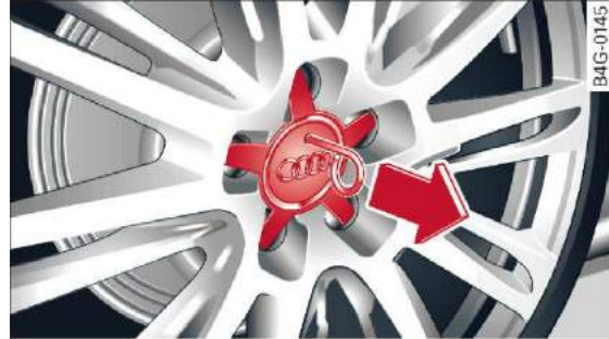
Rys. 235 Wymiana koła: zdejmowanie ostony piasty
