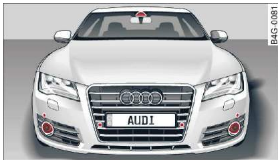
Rys. 106 Przód samochodu: czujniki i kamera wideo
