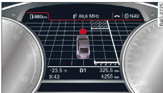
Rys. 170 Wyświetlacz: zidentyfikowane wolne miejsce parkingowe, z informacją, aby jechać dalej
