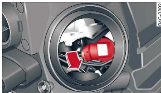
Rys. 257 Reflektor: zamontowanie żarówki światła uniwersalnego/światła skręcania*
