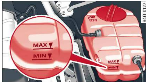
Rys. 220 Przedział silnikowy: oznaczenia na zbiorniku wyrównawczym płynu chłodzącego
