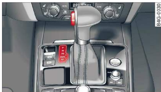
Rys. 101 Fragment konsoli środkowej: dźwignia przełączania z przyciskiem blokującym
