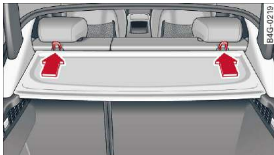
Rys. 182 Oparcie siedzenia z tyłu: zaczepy mocujące Top Tether
