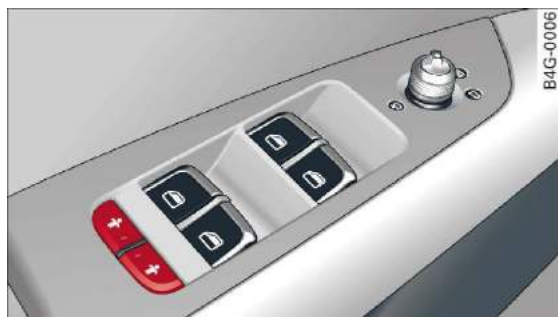
Rys. 28 Fragment drzwi kierowcy: przyciski blokady otwarcia od wewnątrz
