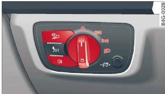
Rys. 31 Tablica przyrządów: wyłącznik świateł ze światłami uniwersalnymi
