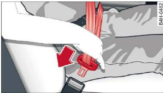
Rys. 189 Siedzenie kierowcy: zamek i zaczep pasa
