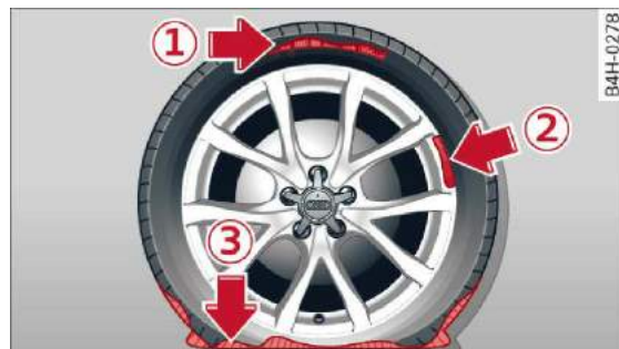
Rys. 233 Uszkodzenia opon, dla których zestaw naprawy nie jest przeznaczony
