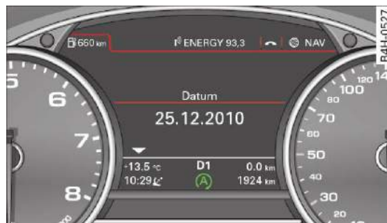
Rys. 87 Zestaw wskaźników: silnik wyłączony (faza Stop)
