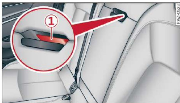
Rys. 75 Środkowe oparcie siedzenia: dźwignia odryglowania
