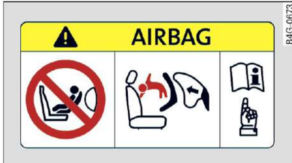
Rys. 65 Ostrona słoneczna po stronie pasażera: nalepka poduszki bezpieczeństwa
