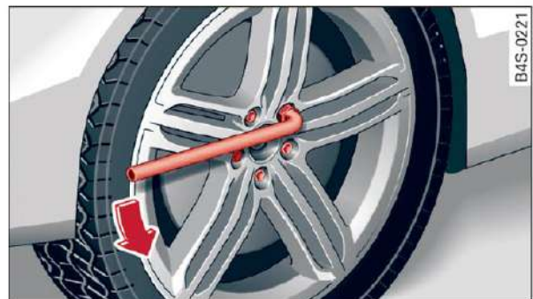
Rys. 206 Koło: poluzowanie śrub koła
