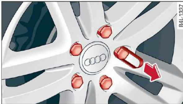
Rys. 204 Koło: śruby koła z nakładkami
