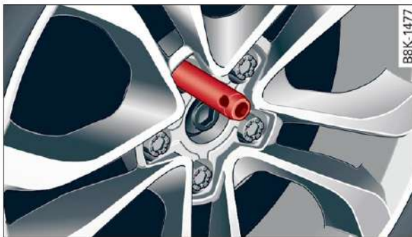
Rys. 210 Koło: trzpień montażowy w najwyższym położonym otworze
