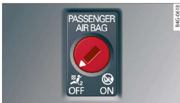
Rys. 63 Przedni schowek: wyłącznik na kluczyk do wyłączenia poduszki przedniego pasażera
