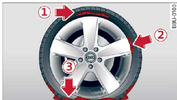
Rys. 201 Opony: niemożliwe do naprawy uszkodzenia opon
