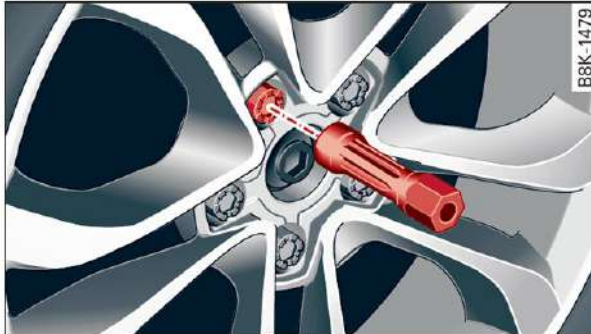
Rys. 209 Koło: klucz z wewnętrznym sześciokątem do obracania śrub koła
