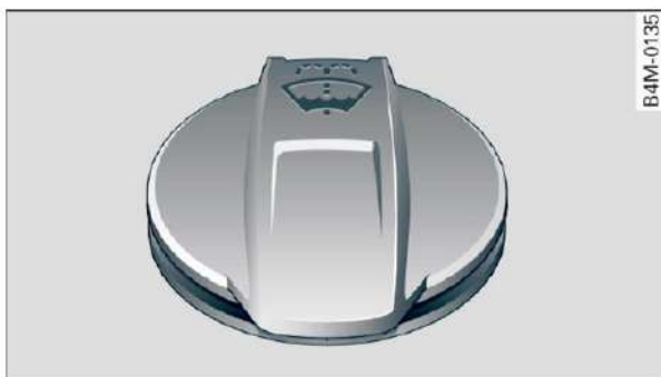
Rys. 195 Przedział silnikowy: pokrywa zbiornika płynu do mycia szyb
