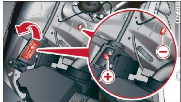
Rys. 211 Przedział silnikowy: przyłącza przewodów do wspomagania rozruchu lub urządzenia do ładowania
