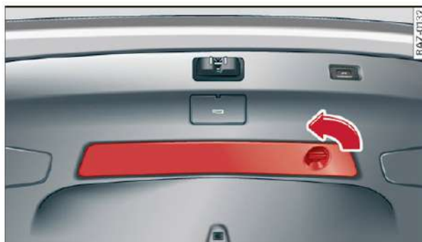
Rys. 198 Pokrywa bagażnika: trójkąt ostrzegawczy
