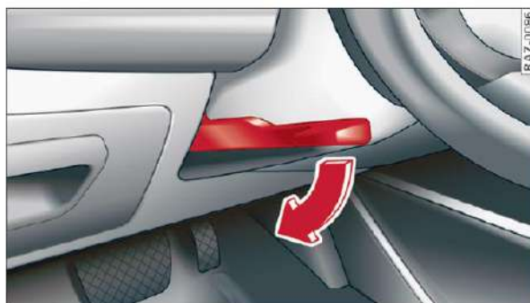
Rys. 52 Kolumna kierownicy: dźwignia regulacji położenia kierownicy
