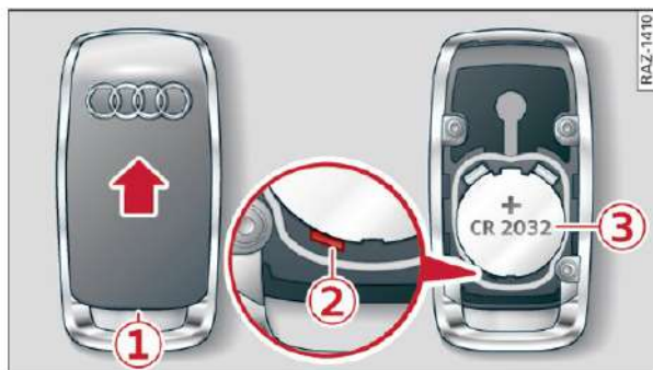
Rys. 82 Pilot zdalnego sterowania: wymiana baterii
