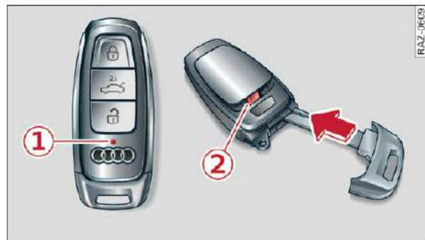
Rys. 31 Kluczyk samochodu: wymontowanie wspornika baterii
