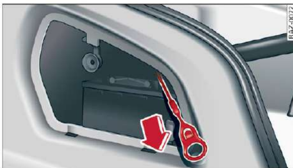
Rys. 183 Przestrzeń bagażnika: odblokowanie pokrywy wlewu paliwa
