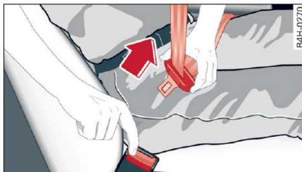
Rys. 60 Odpięcie zaczepu z zamka pasa
