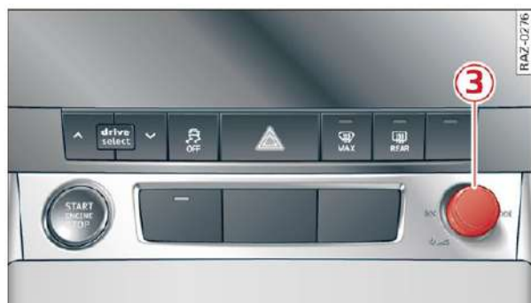
Rys. 22 Przycisk włączania/wyłączania MMI z funkcją joysticka
