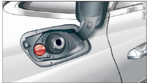
Rys. 184 Tylna, prawa strona samochodu: wykręcanie korka zbiornika AdBlue
