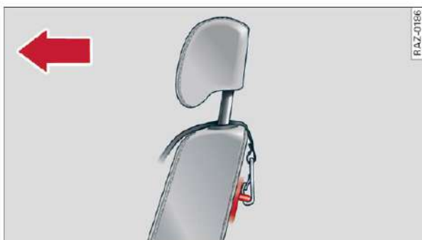
Rys. 68 Oparcie siedzenia z tyłu: zawieszanie górnego pasa mocującego do zakotwiczenia Top Tether
