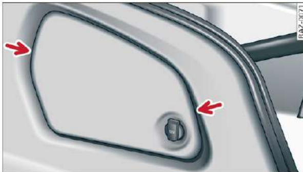
Rys. 182 Prawa pokrywa w przestrzeni bagażnika: wymontowanie pokrywki
