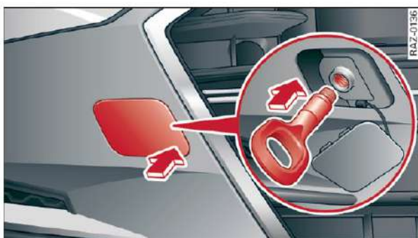
Rys. 213 Zderzak z przodu: wkręcanie ucha holowniczego
