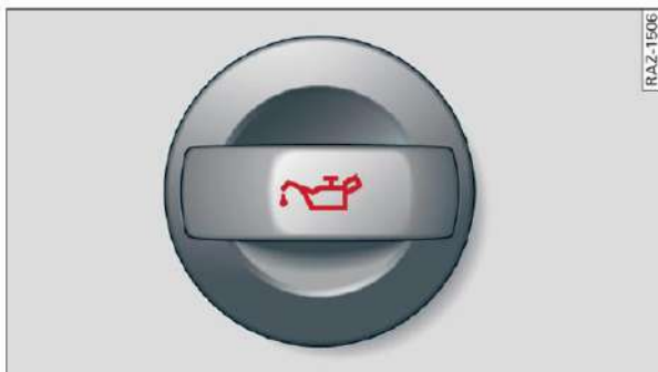
Rys. 191 Przedział silnikowy: pokrywa otworu wlewu oleju silnikowego (przykład).
