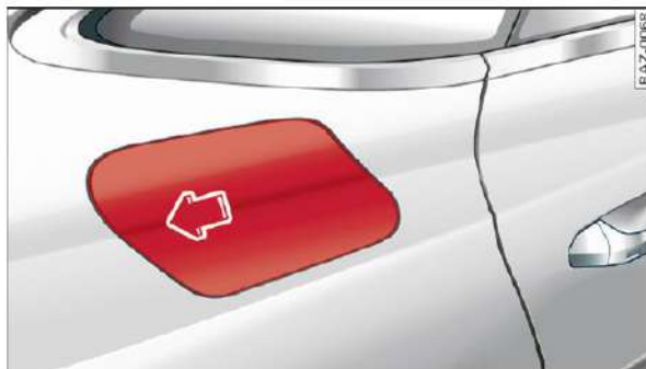
Rys. 179 Tylna prawa strona samochodu: otwieranie pokrywy wlewu paliwa
