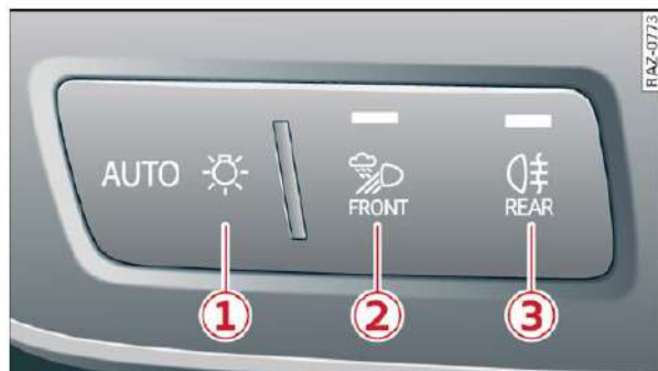
Rys. 40 Tablica przyrządów: moduł przycisku świateł
