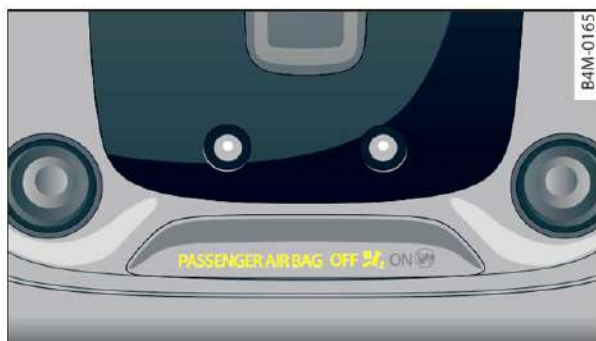
Rys. 64 Tapicerka dachu: lampka kontrolna wskazująca status poduszki bezpieczeństwa przedniego pasażera
