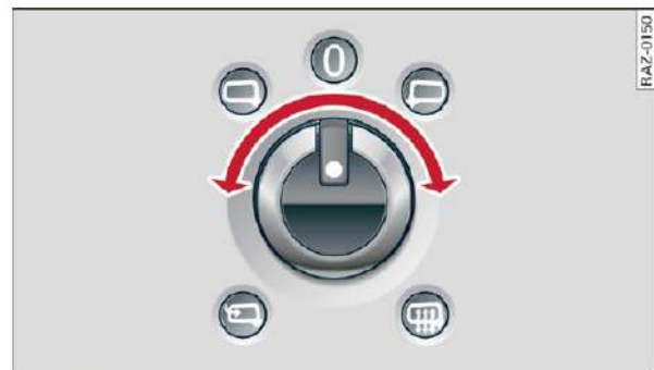
Rys. 45 Drzwi kierowcy: pokrętło lusterek zewnętrznych
