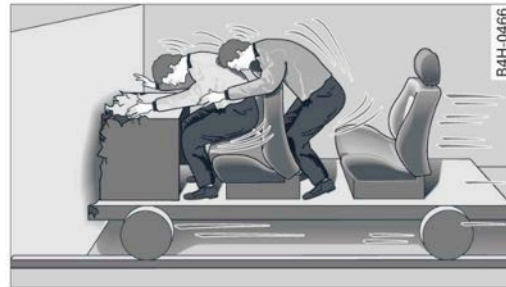
Rys. 206 Samochód uderza w ścianę
