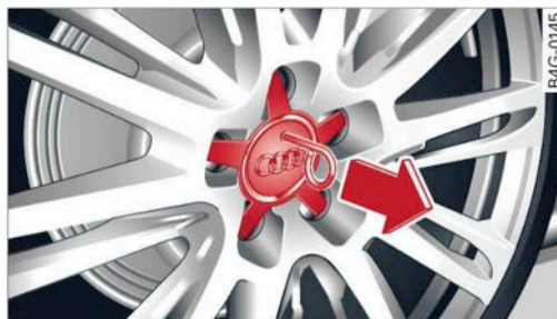
Rys. 265 Wymiana koła: zdejmowanie ostony piasty
