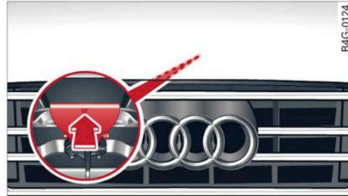
Rys. 243 Przełącznik pod pokrywą przedziału silnikowego
