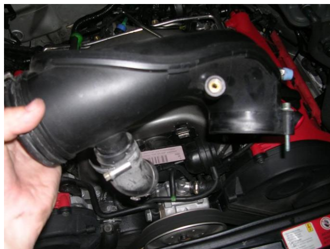
Ściągając dolot, czujnik mamy już jak na dłoni. Uwaga by nie zgubić zawlecжки z czujnika.
